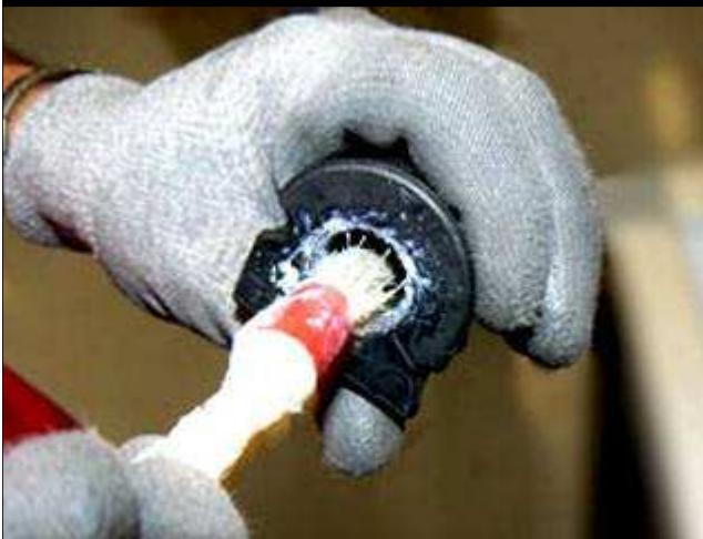
● 在橡胶衬套的内部表面涂抹 1 ml 相同的润滑脂 DuPont 润滑剂 Krytox® 205 GPL 标准级别润滑脂。
